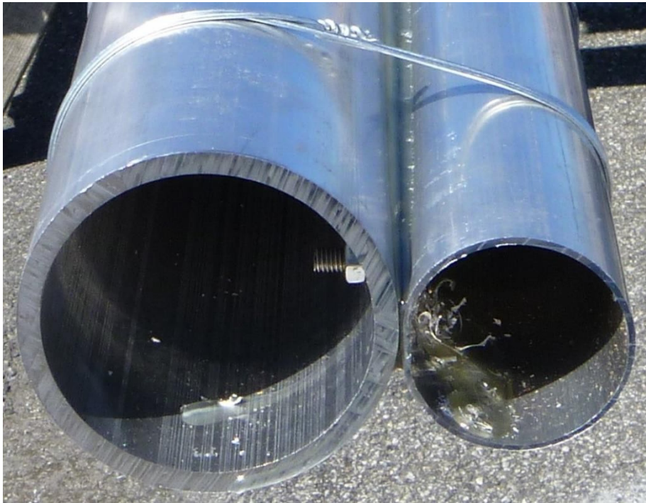
La première vergue tube sur tube pour ED, en 2012: tube principal , Ø80 x 5mm et tube supérieur Ø50 x 1.5mm
