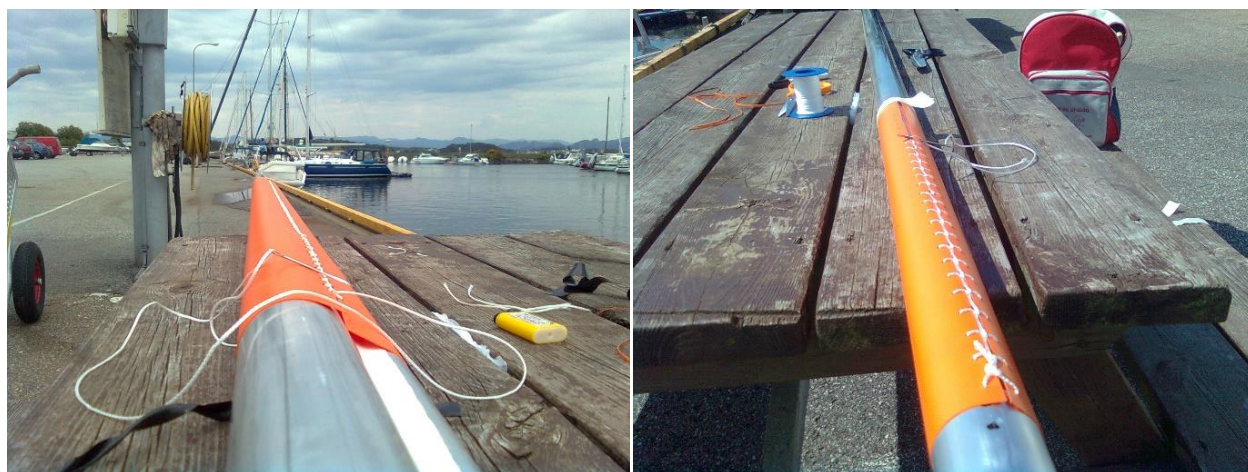
Le tissu en PVC-cloth est cousu sur la vergue et la bôme avec des « points de chevrons de voiliers »
