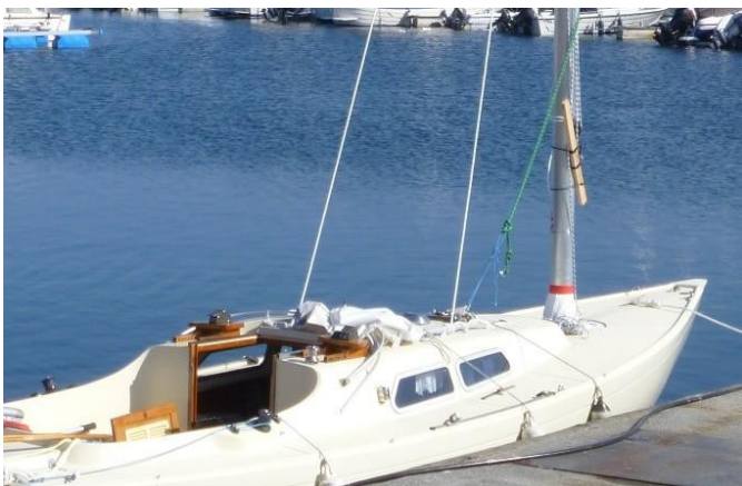
Mât implanté avec la vergue fictive qui maintient la drisse en ordre
