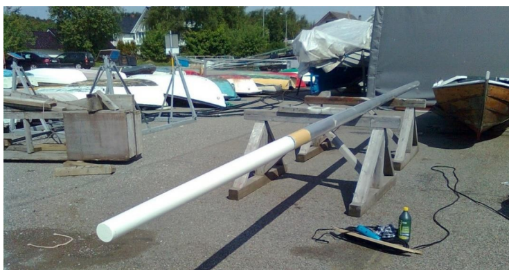
Lundsvågen, 20130530. Emboitement à blanc de 0,4m de la section supérieure de 1,6m en bois dans un tube de 6m de long, de 100mm de diamètre ayant une paroi de 4 mm.
