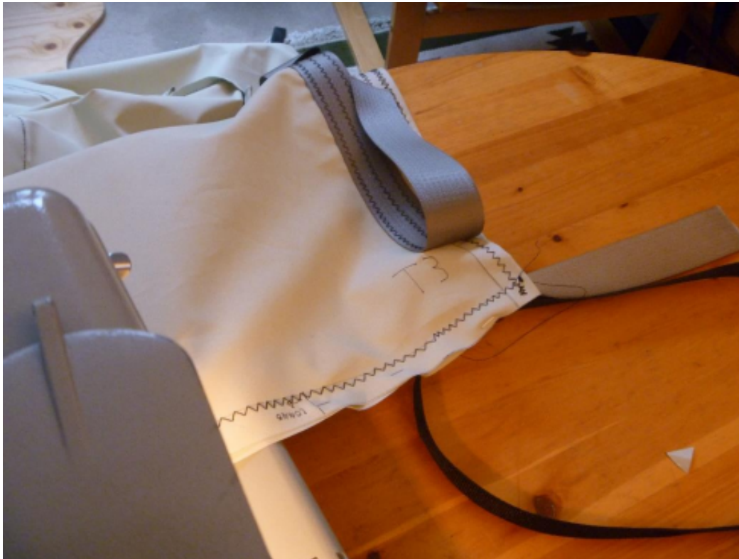
Le début de la couture d'assemblage des derniers panneaux de la voile de Frøken Sørensen . J'ai utilisé beaucoup d'agrafes...
