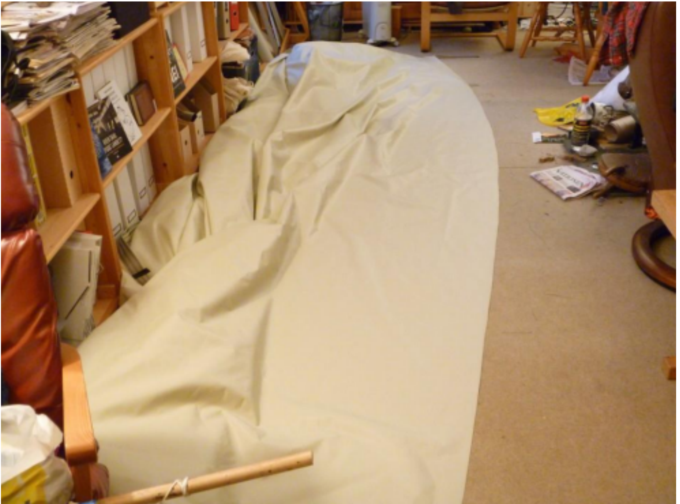
Préparation de l'assemblage des parties base et haute de la voile d' Ingeborg
