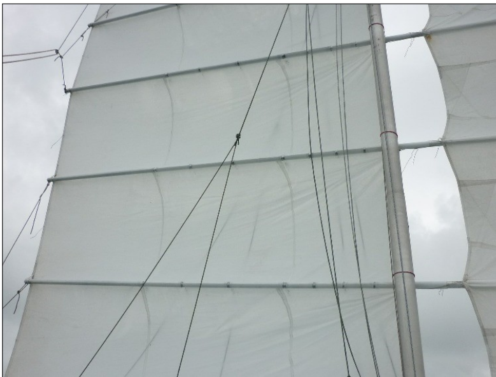
On voit l'élargissement de la couture du panneau principal lorsqu'elle s'approche de la latte du haut de chaque panneau.
