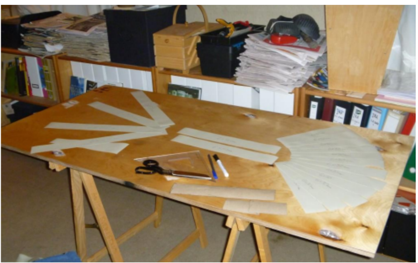
Les bandes de couverture de l'espace vide de la voile d'Ingeborg. Toutes ont 60 mm de large. Cette table temporaire a été très utile pour ce genre de petits travaux...
