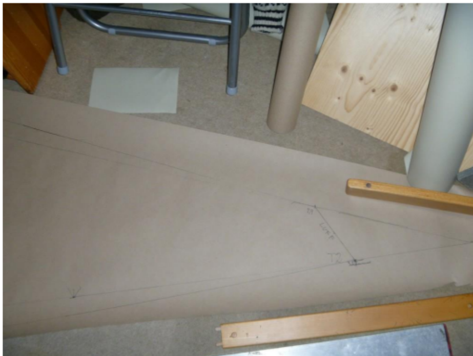
Le gabarit du panneau 2 pour la voile d'Ingeborg , prêt à être découpé.
