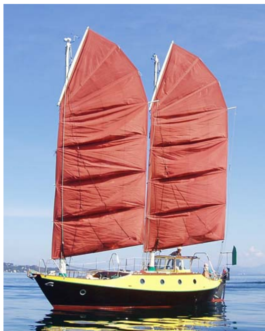
Badger à Stavanger en 2006 avec ses nouvelles voiles cambrées. Le Benford 34' Sailing Dory, avec un gréement de jonque dessiné par Pete hill.
