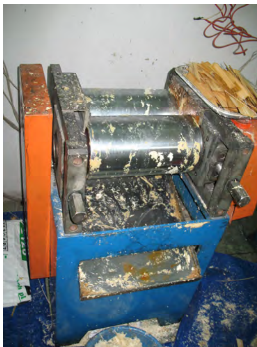
Figure 1.17 : Photographie de la machine de laminage.
